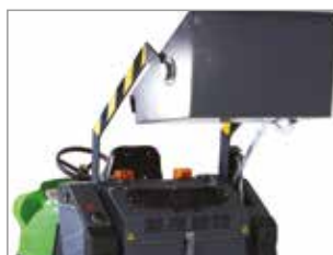
SISTEMA DI SCARICO CON PISTONE IDRAULICO
